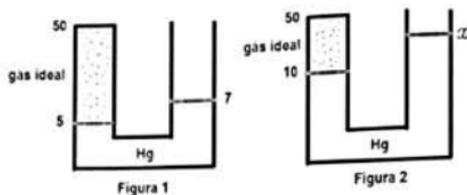
Na Figura 1, é apresentado um manômetro de Hg, graduado em cm, que aprisiona uma certa massa de gás ideal em equilíbrio. Adiciona-se uma nova quantidade de Hg pela extremidade aberta do manômetro e, após o novo equilíbrio, obtém-se a configuração da Figura 2.
