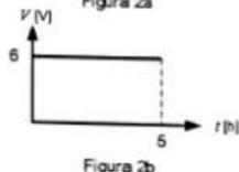
Considere um sistema de carga de bateria hipotético, mostrada na Figura 1, no qual, os gráficos da corrente  $I(t)$  e da tensão  $V(t)$  são mostradas nas Figuras 2a e 2b. Ao longo do período de carga, que é de 5 h, a energia fornecida pelo carregador, em kJ, é:
